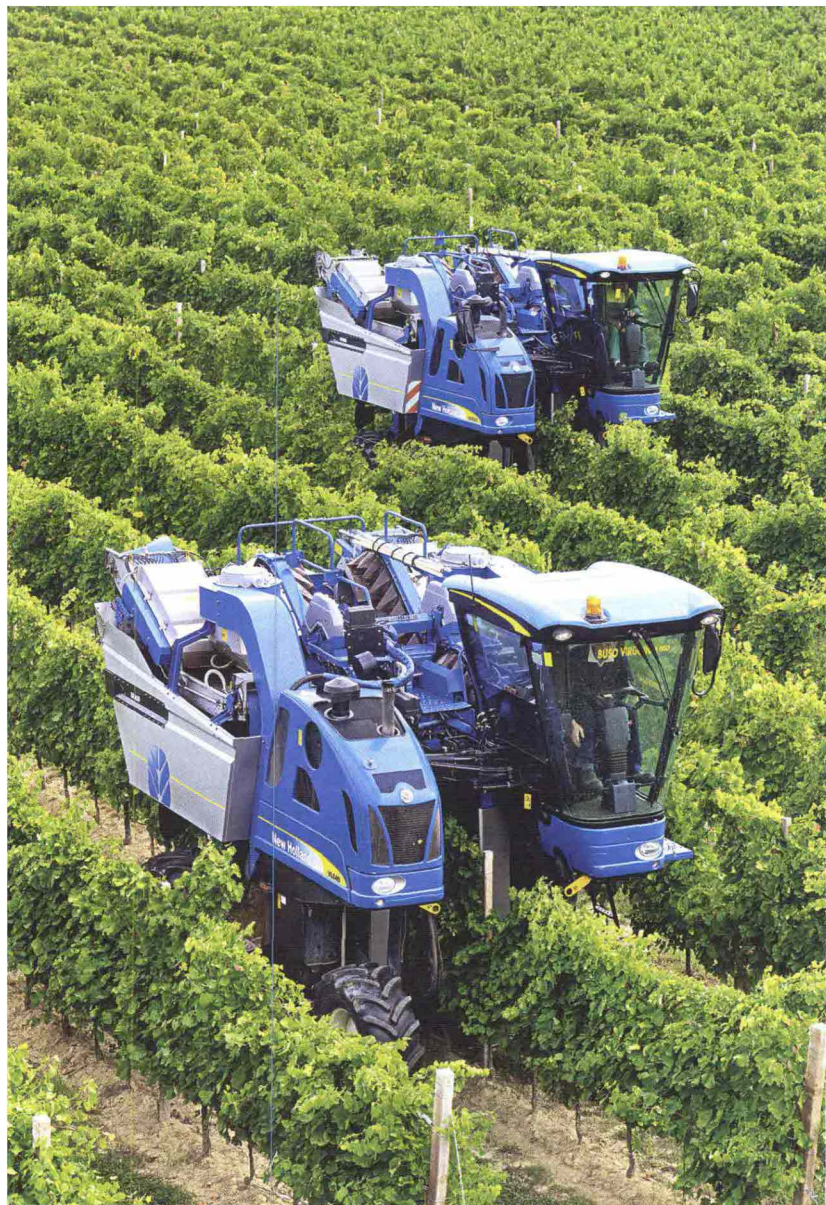
Due vendemmiatrici semoventi a "scuotimento verticale" al lavoro a Tezze di Piave. La raccolta avviene staccando gli acini dai peduncoli.
